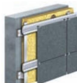
Die hinterlüfteten Fassaden-Wärmedämm-Systeme werden mittels unseren Ecolite-Unterkonstruktionen auf das Tragwerk verankert. Eine grosse Auswahl an Bekleidungsmaterialien und Beschichtungen ermöglichen eine individuelle Gestaltungsform der Fassadenoberfläche.
